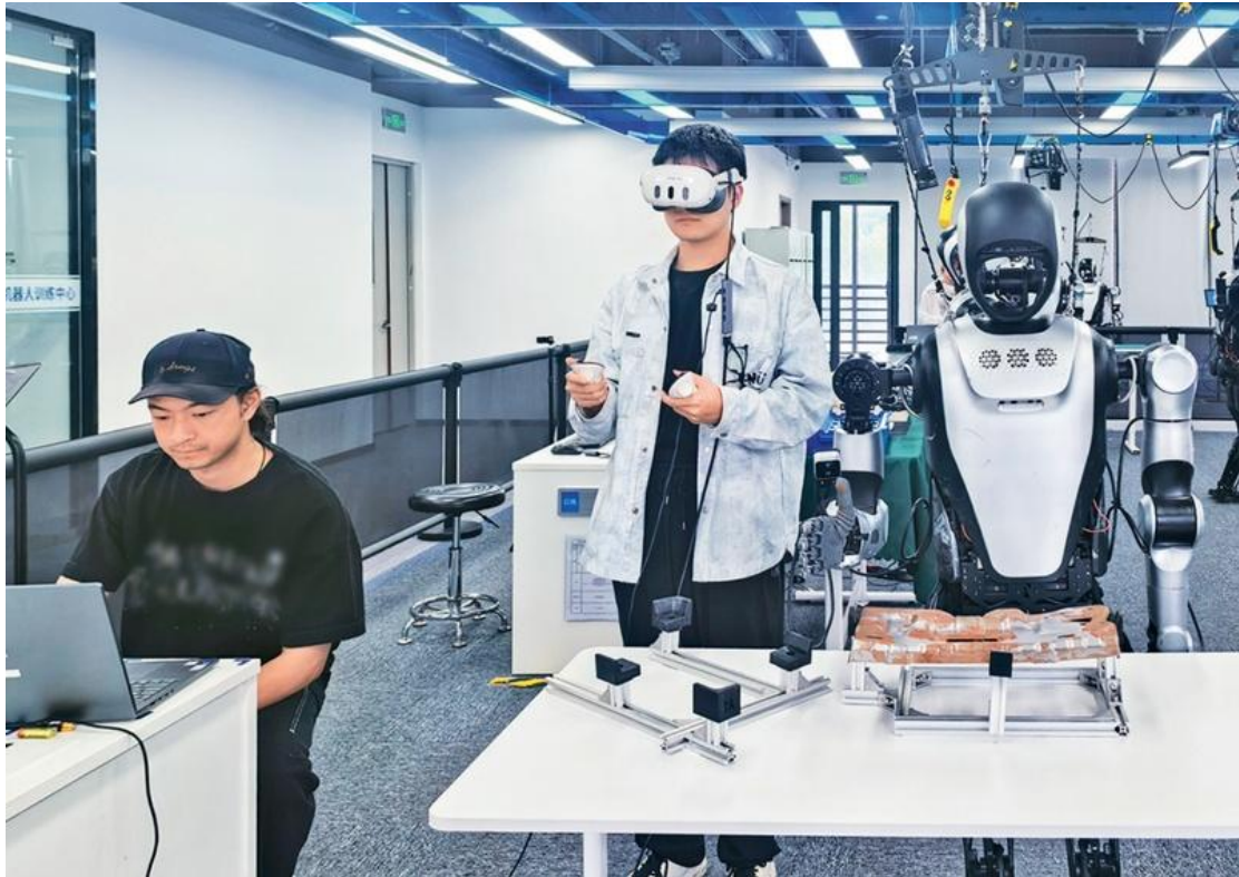
苏州大学未来科学与工程学院聚力交叉融合拔尖创新人才培养，联动区域头部科创企业与产业创新平台，构建“学科交叉、科教融汇、校企融通”三位一体人才培养体系。图为2026年6月12日，学生在实验室利用虚拟现实技术操控人形机器人进行数据采集，用于训练机器人模型。苏州大学未来科学与工程学院供图
